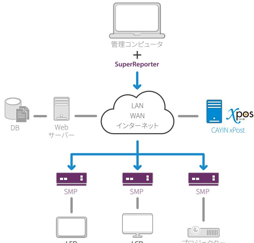
サーバークライアント構成 (CMS サーバー + SMP プレーヤー)
